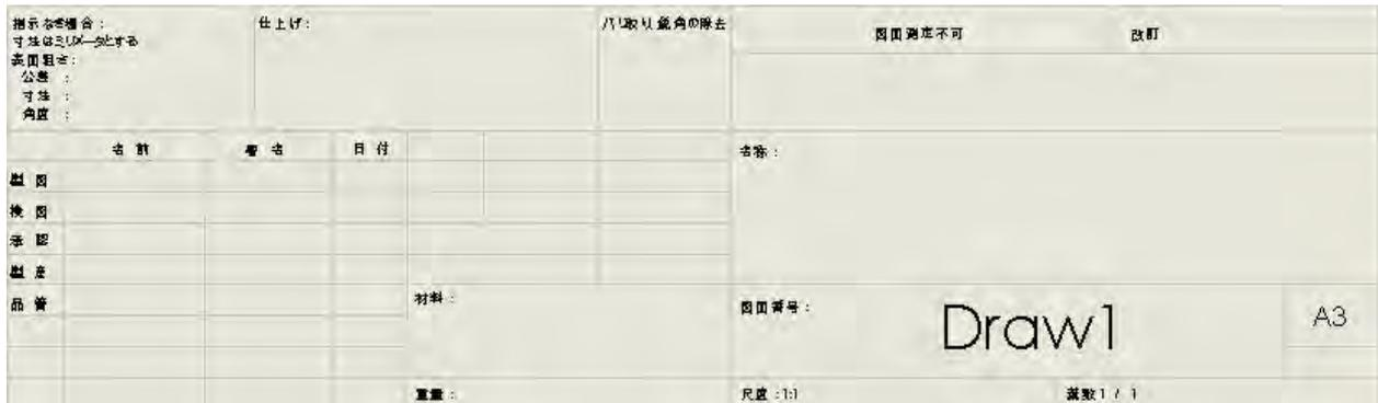
機械系標準図面枠以外の図面枠の例
